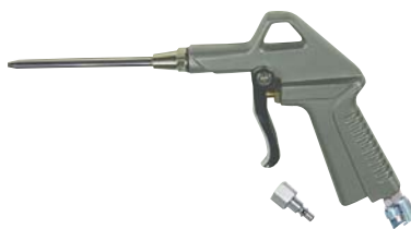
Продувочный пистолет удлинённый Максимальное рабочее давление 4 бар. Расход воздуха 150 л/мин Код 756125-combi
