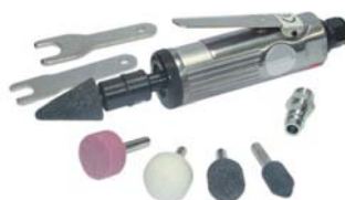
Пневматическая прямая шлифовальная машина с 5 шлифовальными камнями Максимальное рабочее давление 6 бар. Расход воздуха 240 л/мин Код 750153-combi
