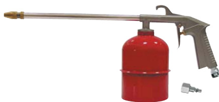
Пистолет для вязких жидкостей. Сопло распылителя, бачок объемом 1 л. Максимальное рабочее давление 6 бар. Потребление воздуха 250 л/мин Код 756042-combi Код 776042-quick
