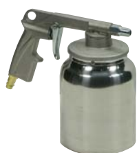
Пескоструйный пистолет с нижним бачком Максимальное рабочее давление 8 бар. Расход воздуха 250 л/мин Код 756062-combi
