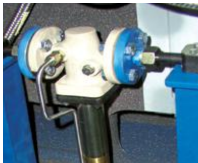
Редуктор уплотняющего газа системы сжатия выхлопных газов.
