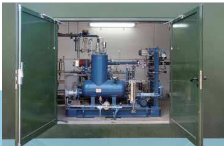
Компрессор AERZEN VMX 110 для сжатия биогаза и биометана
